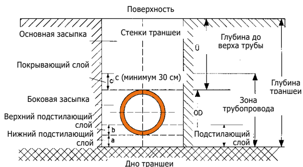
Рис. 3 Устройство траншеи
