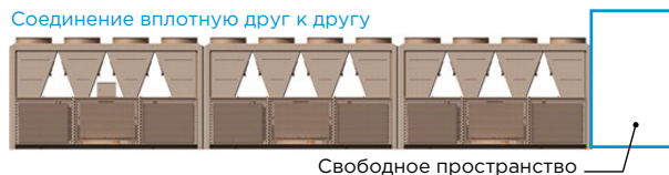
Соединение вплотную друг к другу
