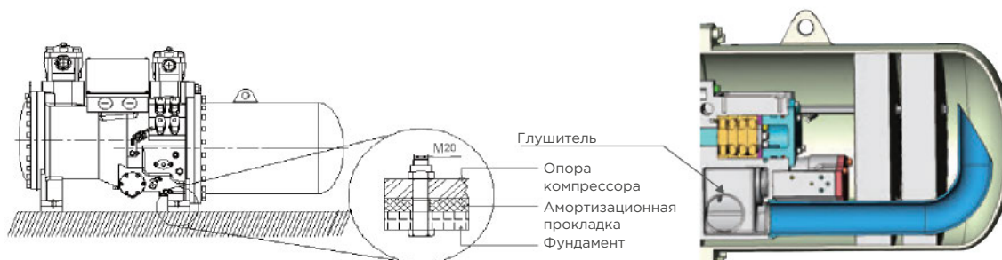
Схема монтажа амортизационной прокладки
