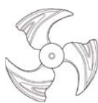
Лопasti с высоким статическим давлением
