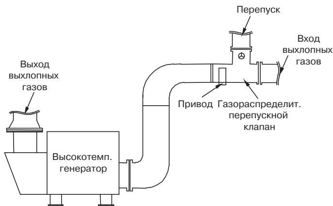
Пример установки газораспределительного перепускного клапана
