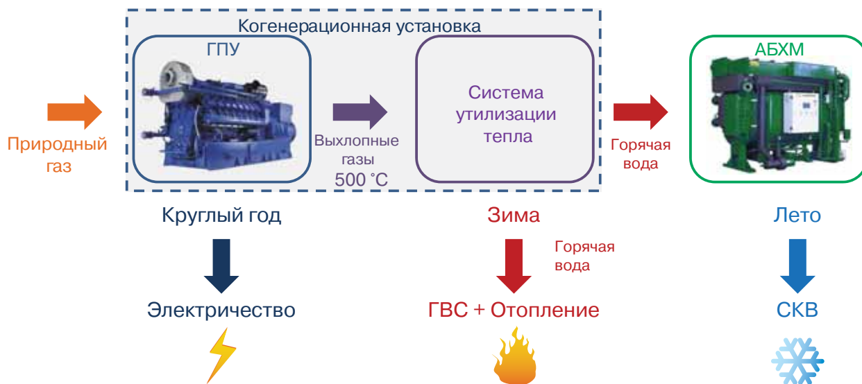
Рис. 2. Вариант применения АБХМ в системах тригенерации
