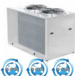
Предназначены для наружной установки. Агрегаты поставляются со спиральными или полугерметичными компрессорами, пластинчатыми или кожухотрубными теплообменниками. Могут комплектоваться гидравлическим модулем.
