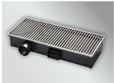
Короб конвектора из оцинкованной стали окрашен методом порошкового напыления. Сверху конвектор закрыт декоративной решеткой, выполненной из дерева, алюминия или стали. Возможно изготовление прибора под заданный радиус с угловыми элементами. Теплообменник укомплектован клапаном воздухоудаления.
