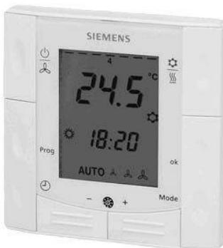
**Термостат комнатный Siemens RDF 310.2/MM** предназначен для управления температурой помещения в отдельных комнатах и зонах. Он управляет: 3-скоростным вентилятором, приводом клапана в 2-трубной системе или 1-ступенчатым компрессором. Подходит для использования в системах со следующими функциями:
