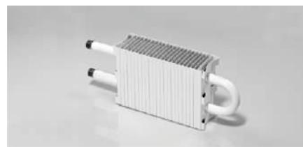
Конвектор предназначен для установки в хозяйственных и вспомогательных помещениях. В напольном исполнении прибор может комплектоваться регулируемыми кронштейнами для точной настройки прибора по высоте. Также возможна комплектация прибора соединительными муфтами для перехода в узлах подключения с наружной резьбы на внутреннюю.
