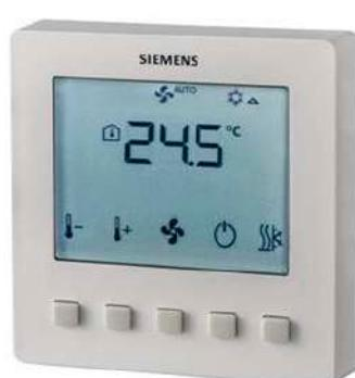
**Термостат комнатный Siemens RDF 510** позволяет выбирать, настраивать и корректировать режимы обогрева, чтобы в помещении стабильно поддерживался нужный уровень тепла. Доступно как автоматическое, так и ручное управление скоростью вращения вентилятора (3 скорости). Термостат подходит для 2-х трубных (обогрев) или 4-х трубных (обогрев/охлаждение) систем. Возможно подключение сервопривода.
