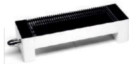
Конструкция конвектора «Коралл Про» представляет собой стойкий к коррозии теплообменник, состоящий из медной трубы и алюминиевых пластин оребрения, а также кожух из оцинкованной стали, окрашенный порошковой полимерной краской с эффектом «муар». Конвектор может комплектоваться встроенным терmostатическим клапаном.
