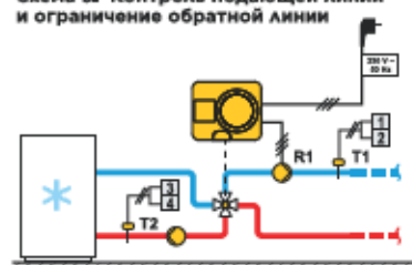
Схема 3. Контроль подающей линии и ограничение обратной линии
