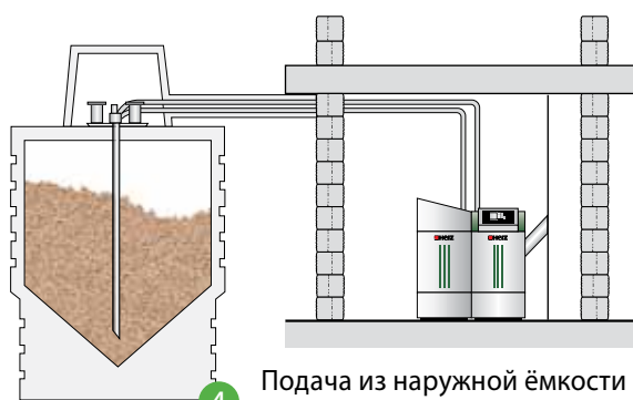
2 Подача спомощью шнека и всасывающего зонда.
