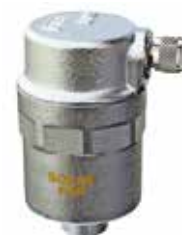
Рис. 1. При отсутствии воздуха в системе вода поднимает поплавков до полного закрытия затвора.
