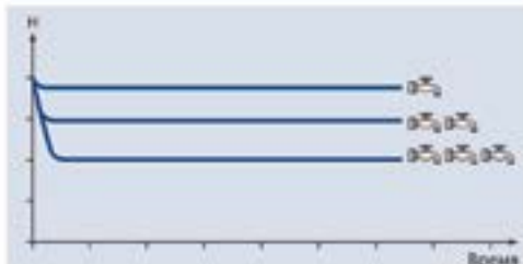
Работа ACUAPRES – стабильное давление в системе при неизменном потреблении воды.
