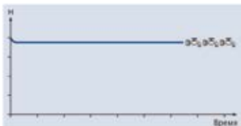
Работа ACUAPLUS – стабильное давление в системе при изменяющемся расходе воды.
