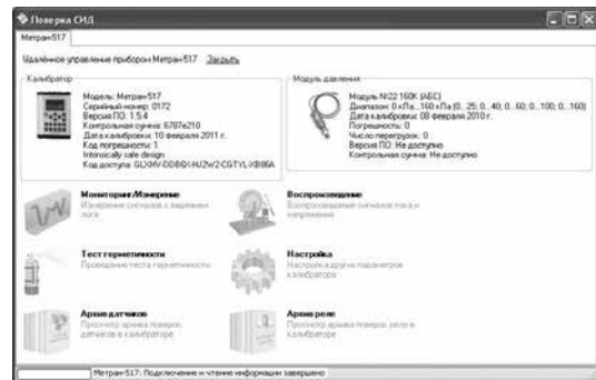
Рис.2. Режим удаленного управления калибратором Метран-517.
