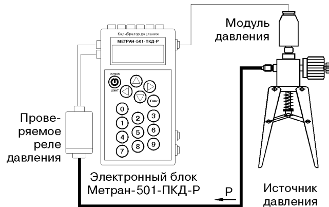
Рис. 3. Проверка реле давления.
