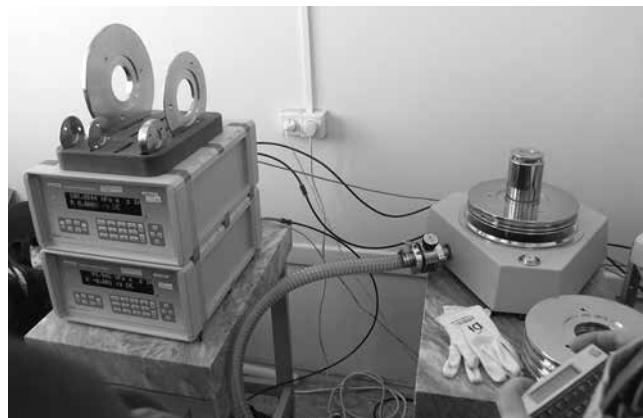
Калибровка на эталоне PG7601 калибраторов-контроллеров давления PPC3 с относительной погрешностью 0,008%
