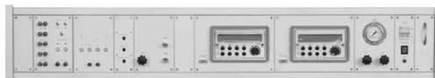
Рис. 1 Пример внешнего вида блока функциональных панелей стенда для поверки 1-4-х датчиков давления и 1-4-х манометров (в т.ч. электроконтактных) с автоматизированным (автоматическим) заданием давления и разрежения.
