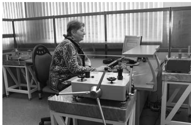
Представитель Челябинского ЦСМ проводит поверку калибратора давления
