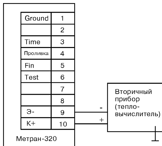
Рис. 1. Схема подключения расходомера Метран-320 к вторичному прибору.
