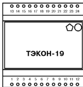
Рис.1. ТЭКОН-19-01М, -07М, -08М, -09М, -11, -12, -13, -14. Типоразмер корпуса "70".
