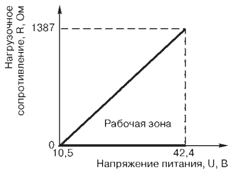
Рис. 1. Выходной сигнал 4-20 мА.
