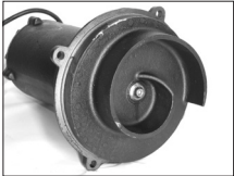
РАБОЧЕЕ КОЛЕСО ОДНОКАНАЛЬНОЕ, ОТКРЫТОГО ТИПА С ИЗМЕЛЬЧИТЕЛЕМ
