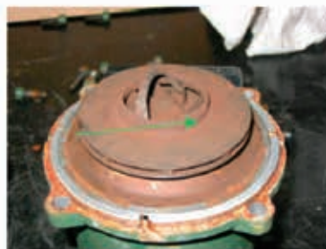
Следы масла и загрязнения рабочего колеса
