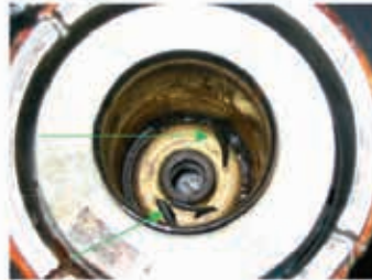
Поврежденный сальник корпуса двигателя
