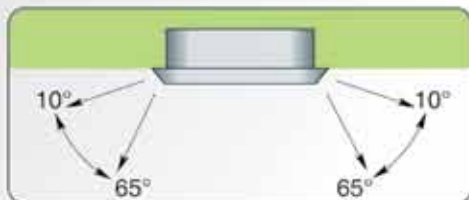
Предотвращение загрязнения потолка
