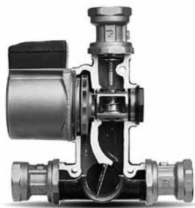
Termovar – термосмесительный узел с предустановленной на заводе настройкой на 55 °С, подключаемый между твердотопливным котлом и системой с баком-накопителем.
