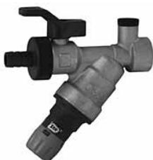
Для систем отопления с замкнутым контуром с запорным клапаном, обратными клапанами, контрольным устройством, грязевиком из нержавеющей стали и редуктором давления, включая винтовое присоединение к шлангу. Отверстия для подключения манометров G 1/4", с двух сторон. Корпус из прессованной латуни.
