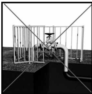
Наземная установка задвижки
