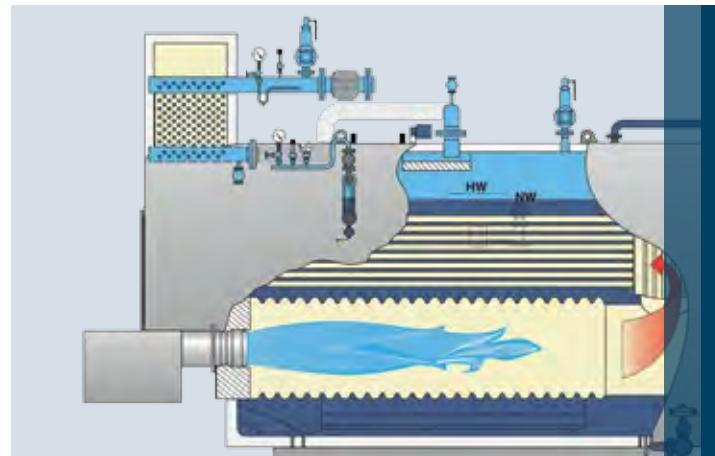
Если вместо насыщенного пара требуется перегретый пар, то на переднюю поворотную камеру можно установить модуль перегревателя. Байпасный клапан постоянно регулирует температуру перегретого пара в большом диапазоне нагрузок. К поверхности дымовых труб имеется удобный доступ через открывающуюся дверцу поворотной камеры.
