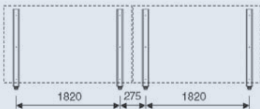
Рис. 247. Типовое исполнение для 2-х горизонтальных солнечных коллекторов
