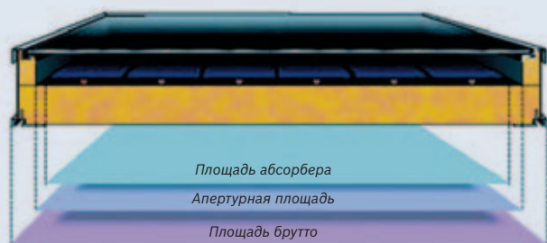
Рис. 147. Виды поверхности плоского солнечного коллектора
