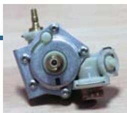
Водяная арматура с чувствительной мембраной
