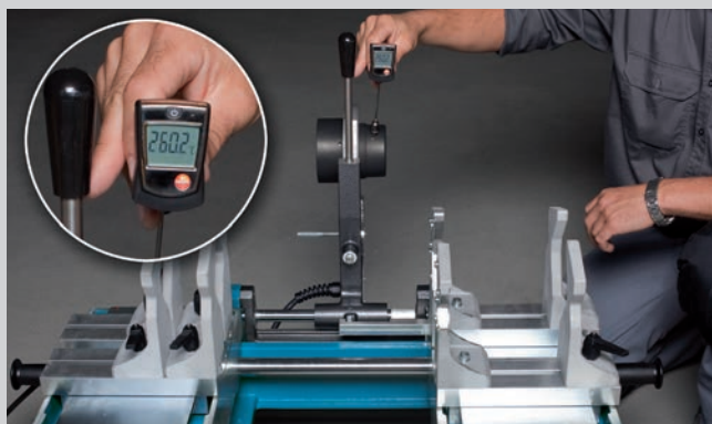
Измерение температуры на сварочной машине aquatherm
