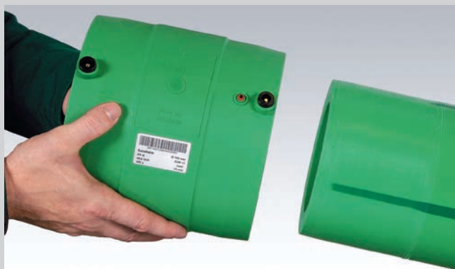
Насаживание электромуфты на зачищенный край трубы
