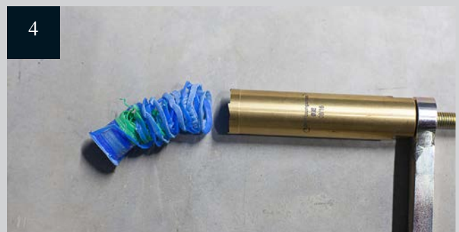
Удаление отходов сверления из инструмента
