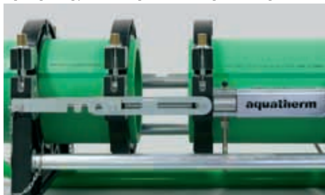
Свариваемые части вставить, выровнять и зафиксировать
