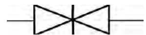
Вариант 3. Знак "Задвижка клиновья или шиберная" Шаровой кран так обозначать неверно, но обозначают так часто.
