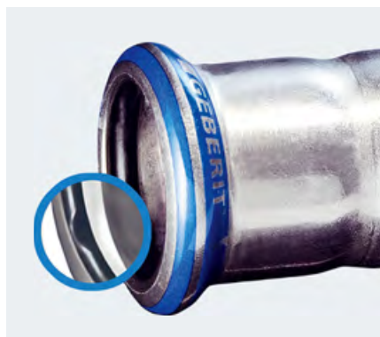
Рис. 3. Кольцевые уплотнения в фитингах Geberit Mapress имеют специальную форму, гарантирующую протечки в необжатом состоянии (такие соединения легко выявляются в ходе стандартного испытания давлением)
