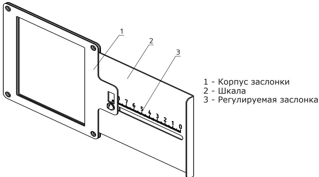
Рис.12 Заслонка вентилятора
