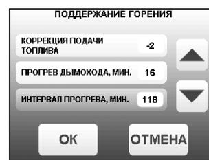
Выход из режима поддержания горения произойдет, когда расчетная мощность превысит заданную минимальную мощность. Например, при снижении температур теплоносителя и воздуха ниже установленных величин.
