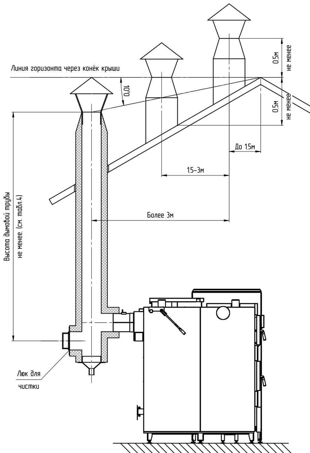
Рис.8 Варианты установки дымовой трубы
