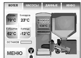
8.5.4. Появится экран, который предлагает запустить котел вручную. Необходимо нажать кнопку «ШНЕК» для заполнения горелки углем. После этого разожгите вручную топливо и кнопкой «ПОДДУВ» включите вентилятор. После того как горение угля станет устойчивым нажмите кнопку «АВТО» для перехода котла в автоматический режим.
