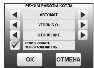
После определенного времени, при отсутствии расхода воды, котел остановится. При снижении температуры в бойлере ГВС котел автоматически запустится. Для правильной работы в режимах, использующих насос ГВС следует настраивать температуру подачи выше требуемой температуры горячей воды;
