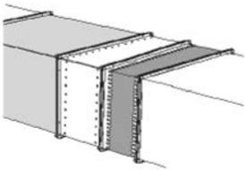
Для монтажа вентилятора рекомендуется использовать гибкие соединительные вставки, которые существенно сокращают передачу шума в воздуховод. Вентилятор может устанавливаться в любом положении. При подключении воздуховодов обратите внимание на направление воздушного потока, указанное на корпусе изделия.
