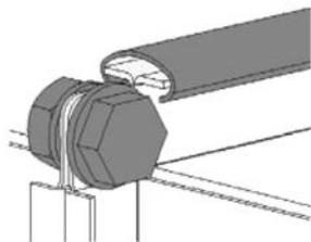
К воздуховодам вентилятор монтируется болтами и С-профилем.
