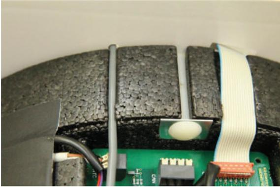
6. Поместите корпус вентиляционной установки в обсадную трубу и соедините съемную часть с основной частью штекерного соединения коммутационного кабеля.
