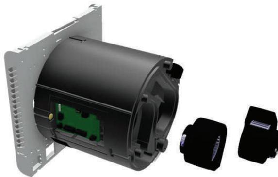
6. Для приточного и вытяжного воздуха используются вентиляторы одинаковой конструкции. Для того чтобы извлечь вентиляторы, отсоедините кабель от клемм FAN1 X4 и FAN2 X3 платы управления. Соблюдайте осторожность, чтобы при извлечении вентиляторов не повредить уплотнительные прокладки.
