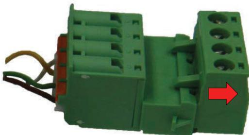
2. Закрепите четыре жилы коммутационного кабеля (J-Y(ST)Y 2x2x0,6) внешней панели управления в резьбовых клеммах съемной части.
