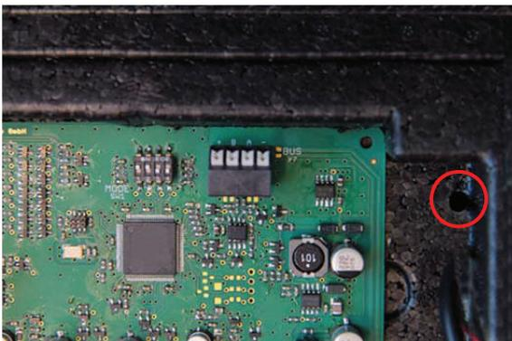
7. Протяните наружу коммутационный кабель и зафиксируйте его в специальной канавке в корпусе вентиляционного блока.
