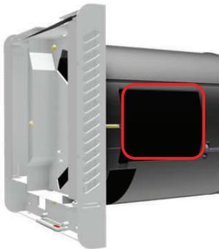
3. Выньте крышку платы управления из паза в корпусе вентиляционной установки со стороны входа шлейфового кабеля.
