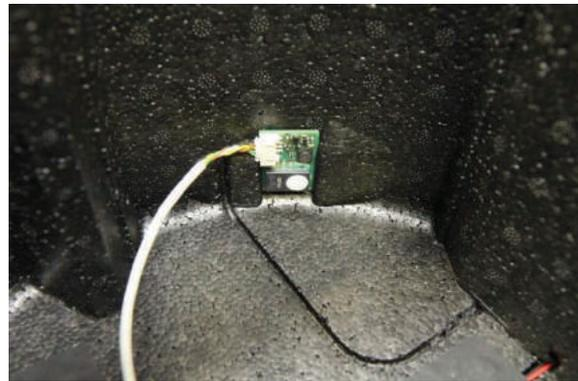
6. Удалите заглушку из расположенного рядом с платой управления отверстия для ввода кабеля.
