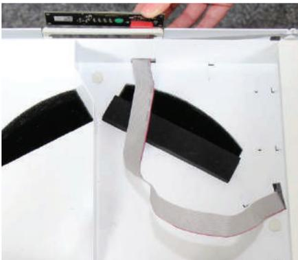
6. Зафиксируйте ленточный кабель с помощью специальных зажимов. Не перекручивайте кабель. Особое внимание уделяйте при укладке кабеля под углом  $90^\circ$ . Зафиксируйте панель управления в гнезде на корпусе лицевой панели.
