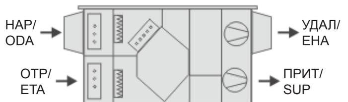
Подключения воздушных каналов обозначены следующими наклейками:
