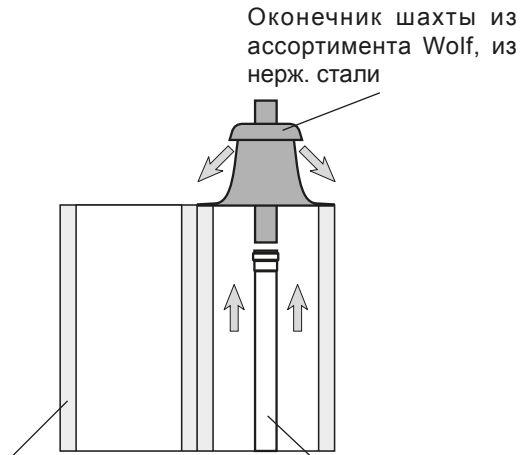
Дымовая труба T400 Система из полипропилена, до 120 °С, сертифицирована CE
