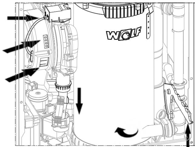
Закрепить стопорную скобу на проходном поворотном соединении.
