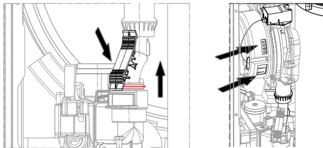
Отсоединить разъемы электрода ионизации и предохранительного ограничителя температуры. Отсоединить разъем трансформатора розжига.
