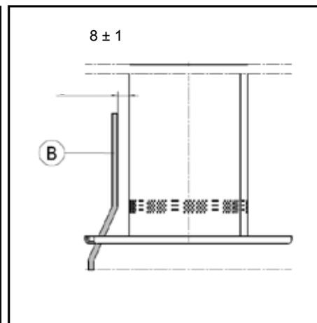
Приподнять отражателя камеры сгорания вверх (при необходимости ослабить). Затем повернуть и вынуть по направлению вниз.
