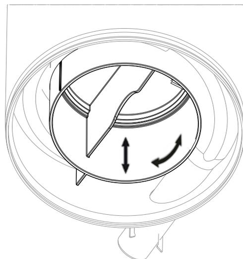
Очистка теплообменника возможна при повернутой наружу камере сгорания и при наличии давления в системе.
