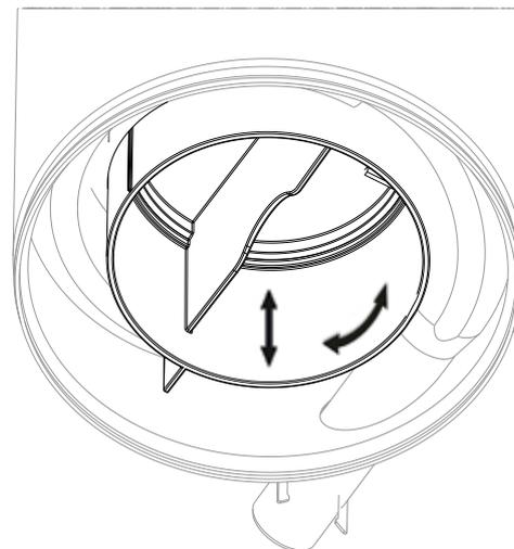
Установить крышку на камеру сгорания и равномерно прижать ее вниз.
