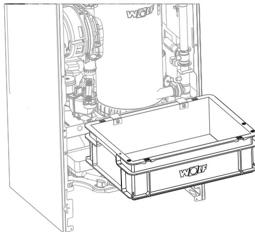
Вынуть стопорную скобу на проходном поворотном соединении.
