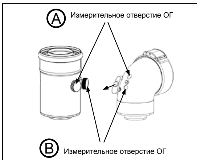
Измерение всасываемого воздуха и параметров ОГ для системы ОГ 60/100 при опциональном исполнении установки
