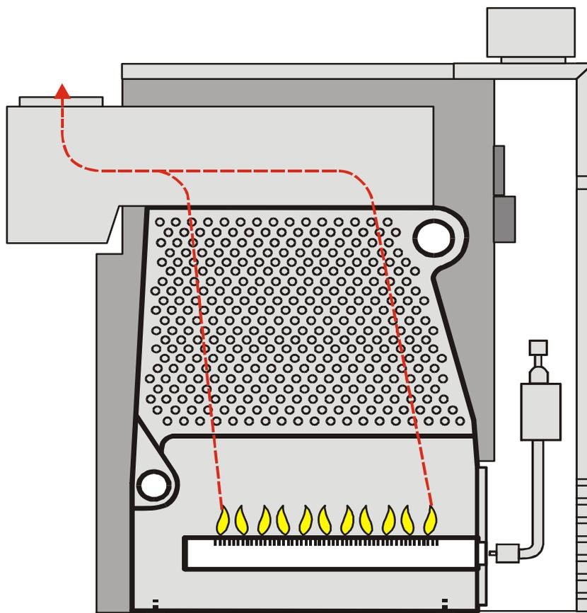
**Чугунные котлы с газовыми атмосферными горелками мощностью до 110 кВт**
