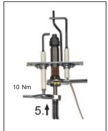
**!** Nach Beendigung der Umrüstung ist eine Gasdichtheitskontrolle durchzuführen!
