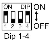
В корпусе модуля управления солнечными коллекторами расположены 4 DIP-переключателя. Доступ к переключателям возможен после снятия крышки или удаления модуля управления.
