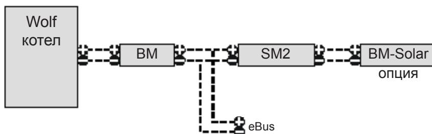
возможно от модуля BM с адресом 0 и модуля BM-Solar. В случае если водонагреватель системы солнечных коллекторов при адресном распределении прикреплен к другому модулю BM, то управление возможно также с этого BM. Если установка содержит два водонагревателя и в системе имеется два модуля BM, то управление системой солнечных коллекторов возможно при помощи обоих модулей BM. (описание параметров SOL07 / P07 и SOL17 / P17).
