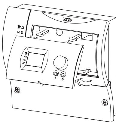
Модуль управления ВМ или модуль управления ВМ-Solar может быть установлен (зашелкнут) в модуль управления солнечными коллекторами. Кроме того, модуль управления ВМ может быть закреплен в настенном цоколе и использоваться в качестве устройства дистанционного управления.
