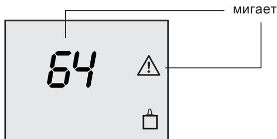
При устранении неисправности, показание на дисплее возвращается к стандартному.
