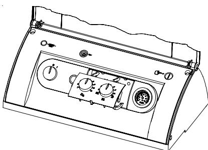
4. Klik de frontplaat vast. Steek daarna de draaiknop voor warm water en de draaiknop voor verwarming in met de wijzer op "5". Draai daarna de draaiknopen voorzichtig tegen de linker en rechter aanslag. Als de draaiknop niet tot tegen de linker en rechter aanslag kan worden gedraaid, moet de draaiknop worden afgetrokken en 180° worden gedraaid.
