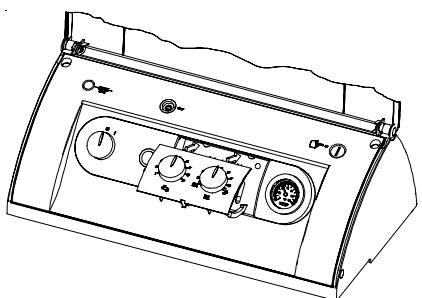
4. В образовавшееся отверстие на панели управления котловой автоматики установить панель с регуляторами. (Панель входит в комплект поставки настенного цоколя). Регулятор температуры ГВС и регулятор температуры воды в системе отопления установить на "5". Затем аккуратно перевести регуляторы до упора влево и вправо. Если не удается перевести регулятор в крайнее левое или крайнее правое положение (до упора), то необходимо вытащить регулятор и повернуть его на 180°.
