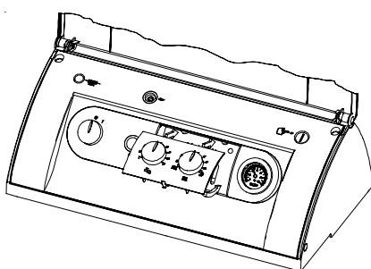
4. Encajar la placa frontal con los clips. A continuación, introducir los mandos de a.c.s. y de calefacción con las marcas señalando la posición "5". Acto seguido, girar los mandos con precaución hasta el tope izquierdo y derecho. Si un mando no se deja girar hasta el tope derecho e izquierdo, hay que sacarlo y girarlo 180°.
