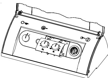
4. Frontblende einclipsen. Danach den Drehknopf für Warmwasser und den Drehknopf für Heizung mit Zeiger auf "5" einstecken. Anschließend die Drehknöpfe vorsichtig auf Links- und Rechtsanschlag drehen. Lässt sich der Drehknopf nicht auf Rechts- und Linksanschlag drehen, muss der Drehknopf abgezogen und um 180° gedreht werden.
