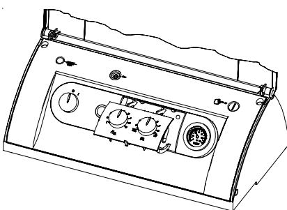
4. Inserire il pannello frontale con le clips. Successivamente inserire la manopola per acqua calda e quella per il riscaldamento con l'indice posizionato su "5". Dopodichè girare le manopole con cura fino all'arresto destro e sinistro. Se non è possibile girare la manopola sull'arresto destro e sinistro, la stessa manopola deve essere tolta e deve esser girata di 180°.
