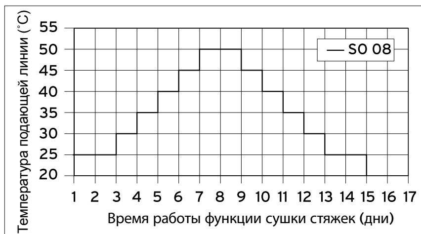
Рис. 6.1 Время выполнения автоматической программы сушки цементных стяжек (параметр SO08 = 50\text{ }^{\circ}\text{C} )
