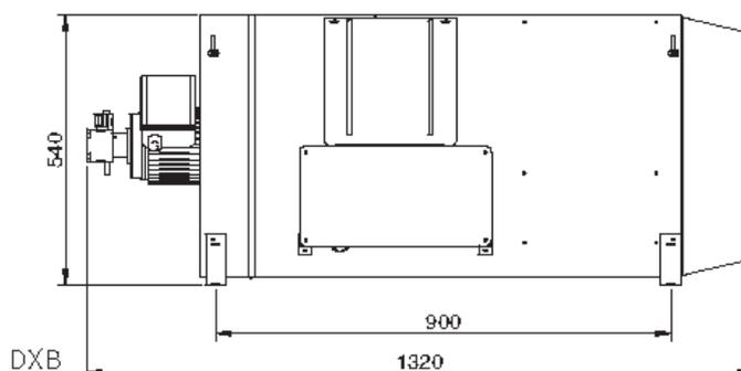
Воздухонагреватели серии **ЕСО** с забором воздуха на горение с улицы специально разработаны для теплиц и птичников. Это надёжные и высокоэффективные воздухонагреватели прямого нагрева работающие на газе или дизельном топливе.
