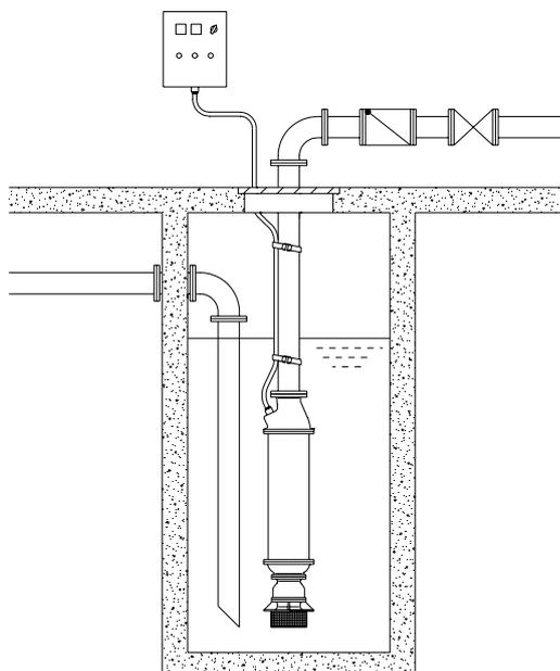
Рис. 5-1: вертикальный монтаж в шахте
