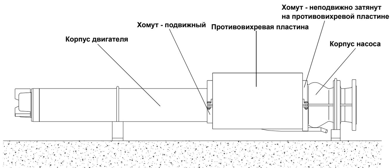
Рис. Е-1: Монтаж и демонтаж противовихревой пластины
