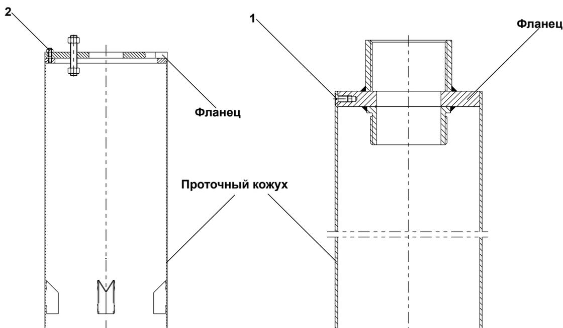
Рис. G-2: Проточный кожух установлен вертикально, заполнение после демонтажа
