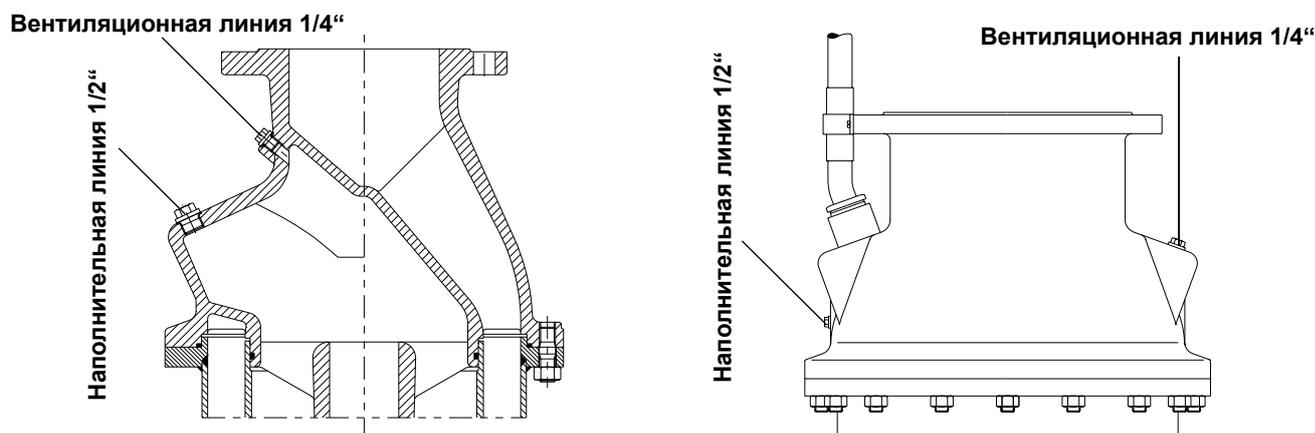
Рис. D-2: Старое и новое исполнение патрубков для наполнительно-вентиляционной линии
