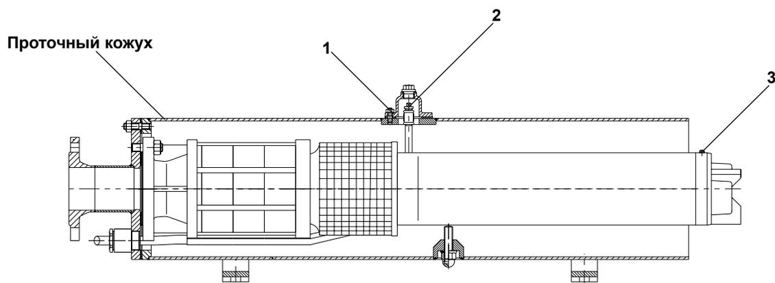
Рис. G-1: Проточный кожух установлен горизонтально, заполнение без демонтажа
