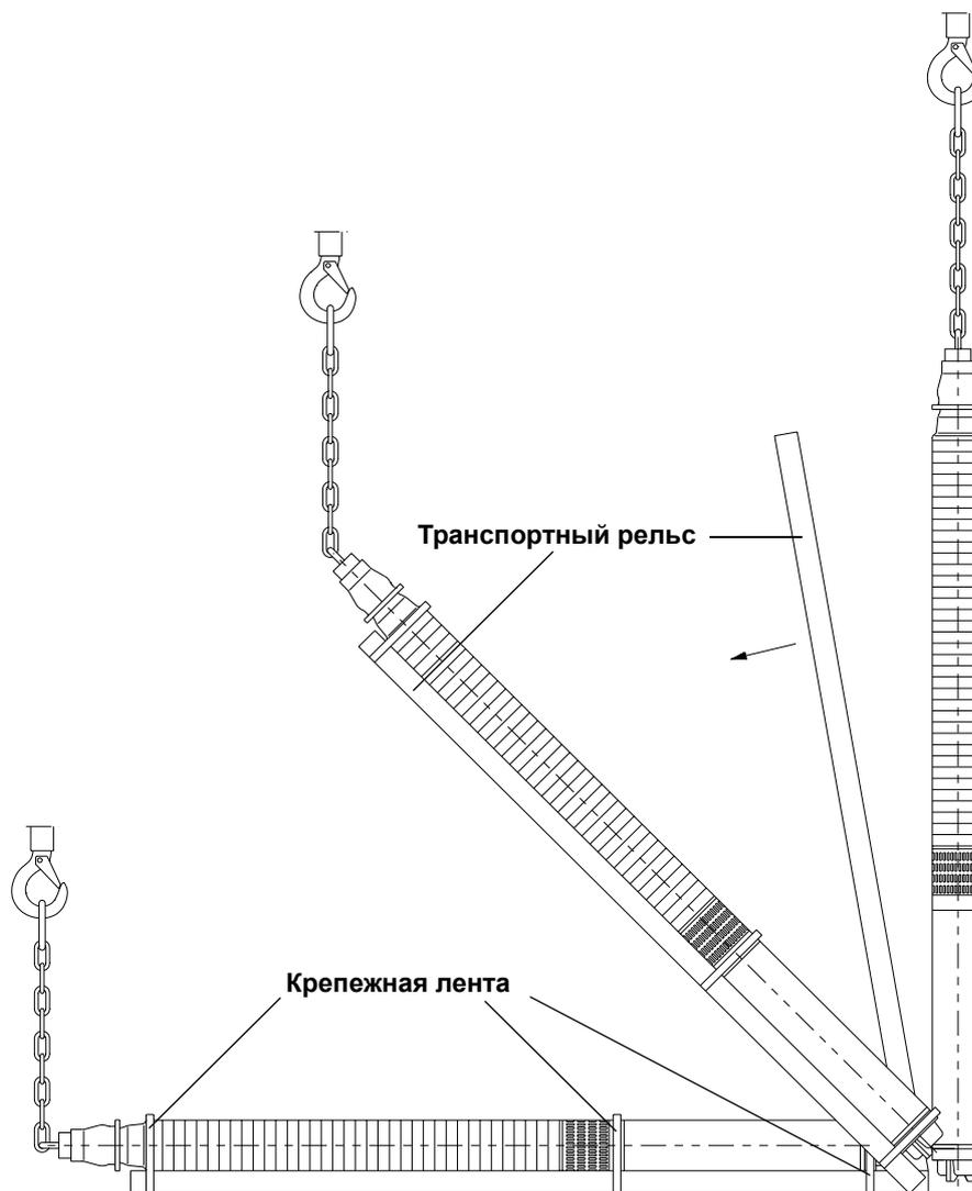
Рис. F-1: Длинное оборудование на транспортном редбсе
