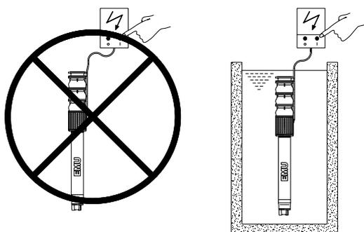
**Чтобы обеспечить необходимое охлаждение, при работе оборудование этого типа должно находиться всегда в погруженном состоянии! Соблюдайте также минимальное погружение под воду. Сухой ход категорически запрещен!**
