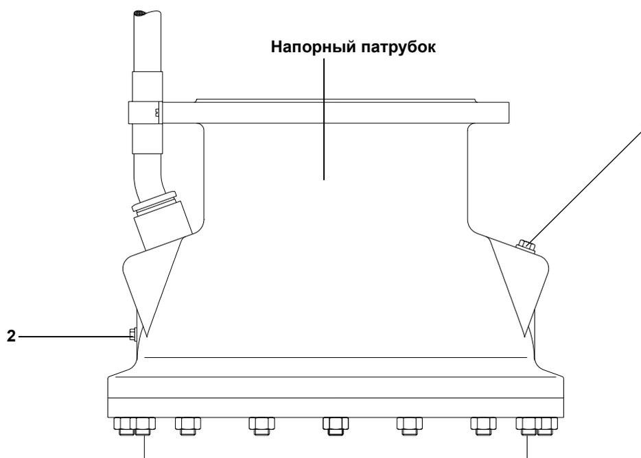
Рис. 5-4: Заполнение двигателя
