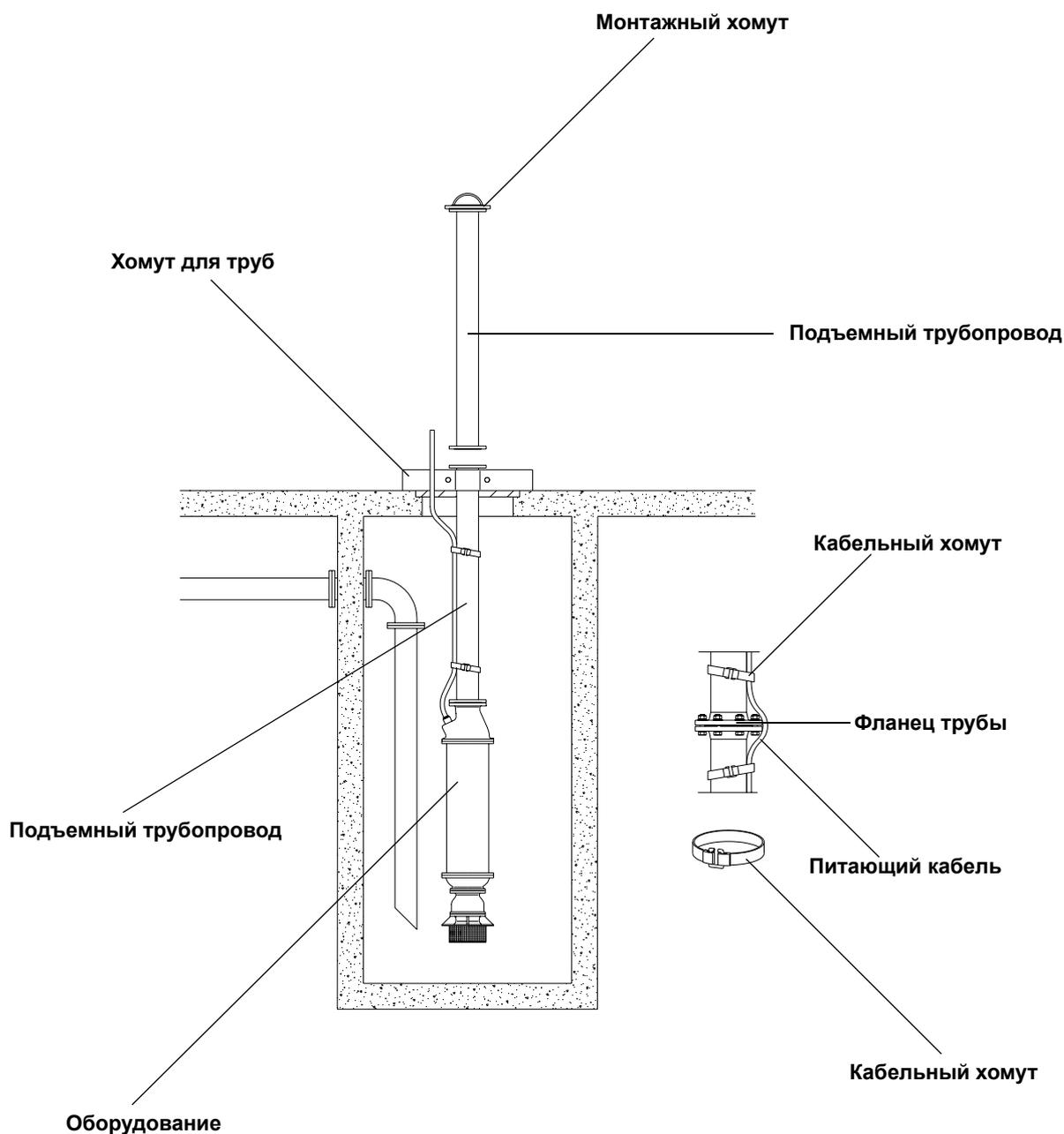
Рис. 5-5: Монтаж оборудования в резервуаре
