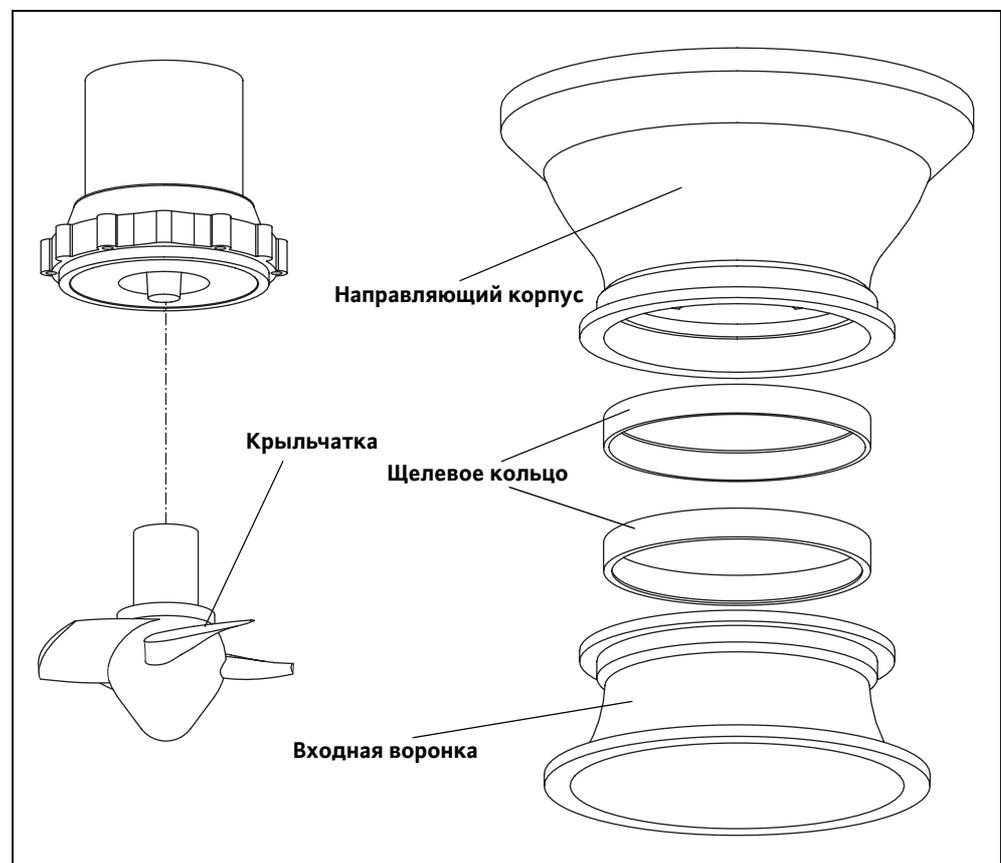
Рис. 3-1: Крыльчатка
