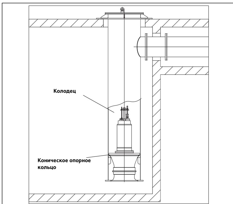
Рис. 5-1: Монтаж в трубе со сливом под полом
