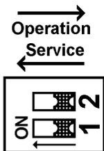
Внутри модуля находится многопозиционный переключатель (Рис. 3) для переключения показаний дисплея (выключатель 1) и для переключения на внешний датчик давления (не тот, что на фланцах насоса) для входного напряжения 0...10V (выключатель 2):
