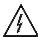
Si van a realizarse trabajos de mantenimiento o reparación, la bomba debe estar libre de tensión y debe protegerse contra el rearranque.
