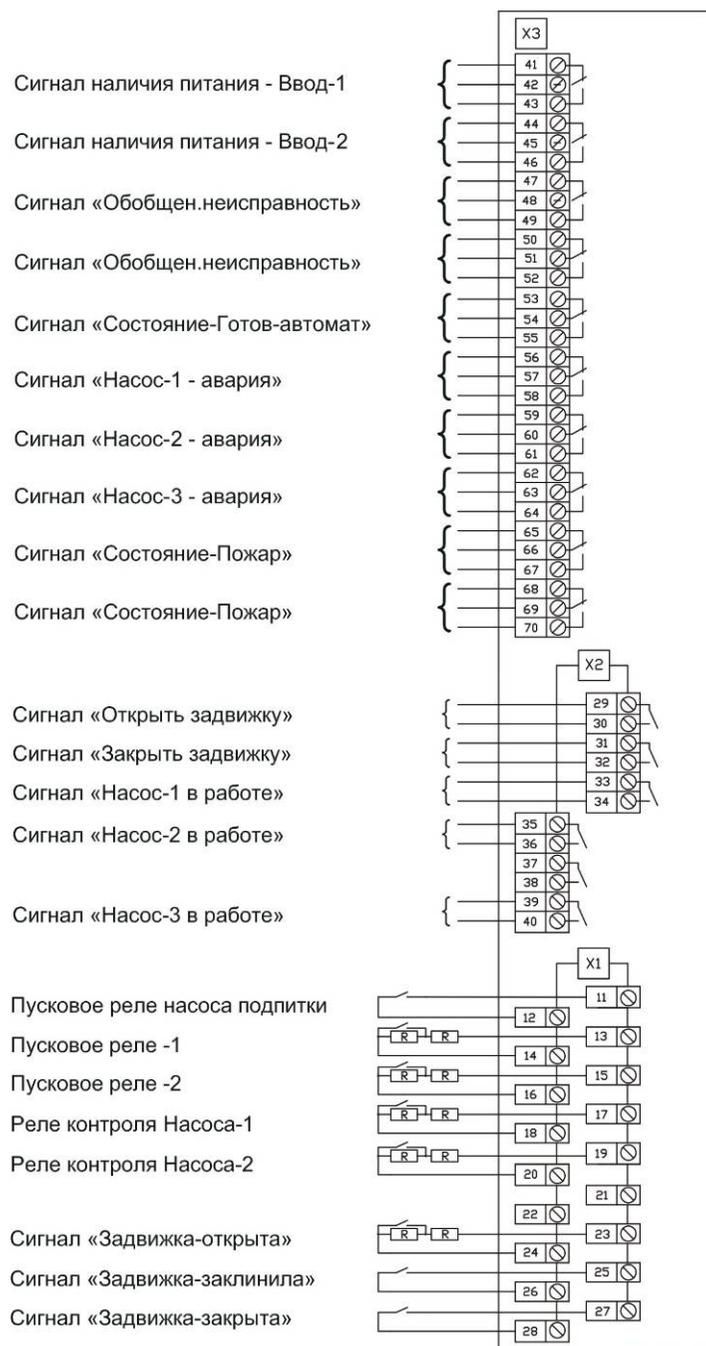
Рис.4 Схема подключения сигнальных цепей (X1, X2, X3)
