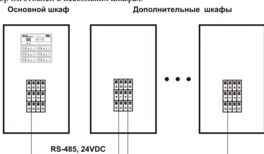
На основном шкафу установлена панель управления с контроллером системы для управления всеми насосами и плата ввода/вывода для подключения внешних датчиков системы.
