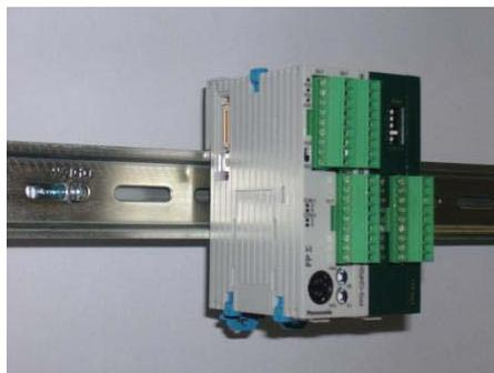
в) Откройте защелку для монтажа GLT – базового модуля на ДИН-рейку.
