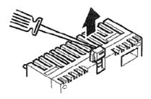
с) снимите крышку разъема расширения на PLC-контроллере отверткой, крышка не будет больше использоваться.
