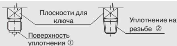
Момент затяжки зависит от используемого уплотнения. Для позиционирования манометра в таком положении, где наиболее удобно считывать показания, рекомендуется использовать зажимную муфту или накидную гайку. Если манометр оснащен приспособлением для продувки, то его следует предохранить от блокировки вследствие попадания компонентов и грязи.
