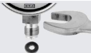
Для правильного уплотнения присоединений манометров с параллельной резьбой ① следует использовать подходящие уплотнительные кольца, уплотнительные прокладки или профильные уплотнения фирмы WIKА. Уплотнение конической резьбы (например, резьбы NPT) осуществляется посредством оснащения резьбы ②, дополнительным уплотнительным материалом, как, например, лентой PTFE (EN 837-2).
