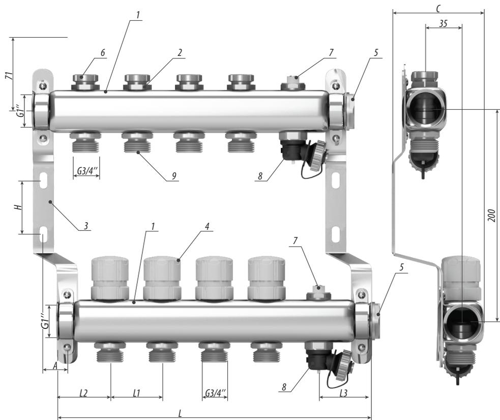
1 – Корпус коллектора, 2 – Расходомер с регулировочным клапаном, 3 – Кронштейн, 4 – Клапан запорный, 5 – Заглушка, 6 – Рукоятка, 7 – Воздухоотводчик, 8 – Кран дренажный, 9 – Отвод.
