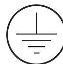
Место подсоединения заземления (на панели рядом с местом подсоединения)
